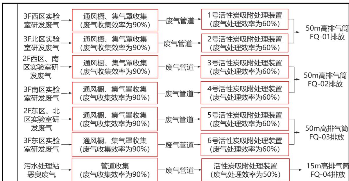
图 2-8 现有项目废气收集、处理示意图
